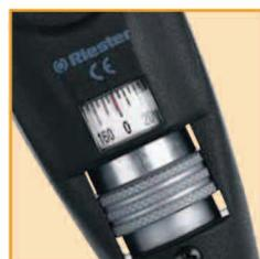
La franja y el punto se giran 360° con el tornillo moleteado. El ángulo se lee directamente en la escala.
